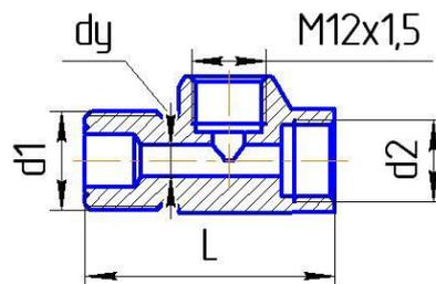
Рис.1 Переходник ДЖЕТ 000 270 003 (-01)    Рис.2 Переходник (под манометр) ДЖЕТ 000 270 003-02
