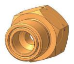
Кольцевой выступ на плоскости, обращённой к вентилю, обеспечивает герметичность без дополнительного уплотнительного кольца.
