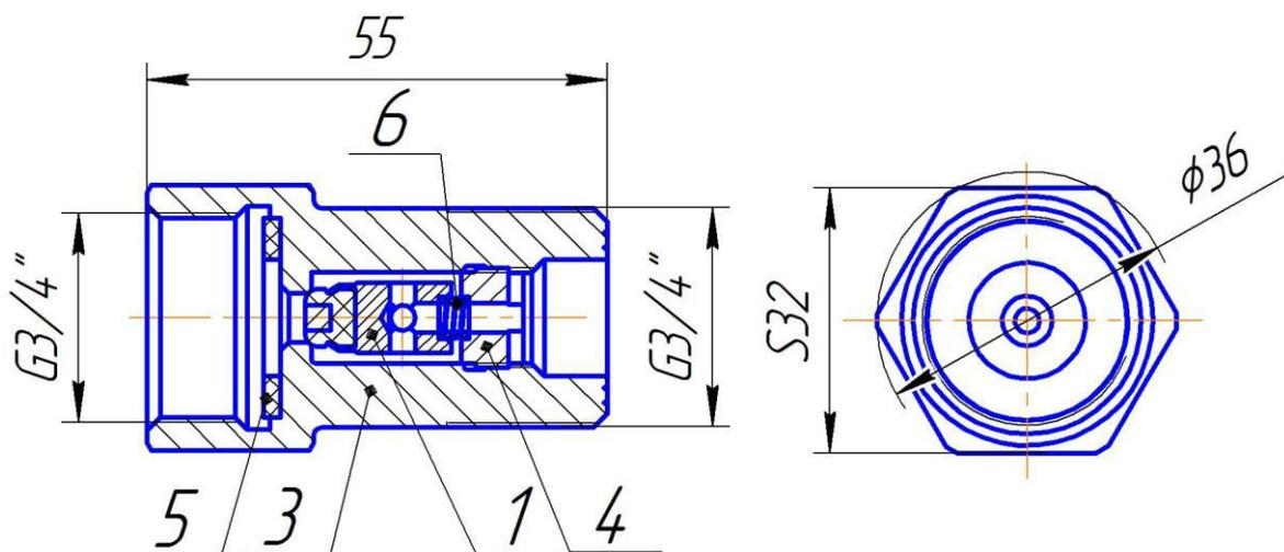
Рис.1 Клапан обратный КО-Кк рамповый ДЖЕТ 312 00 00 00
