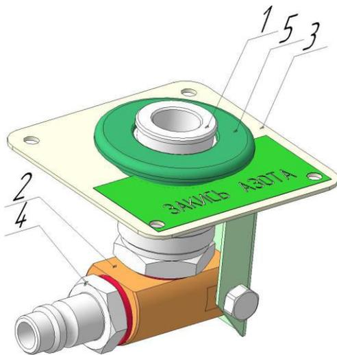
**Рис.1 Клапан быстроразъемный СКБ-2 (одинарный)**
