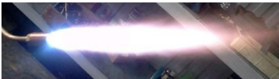
Рис.4 Горелка ГП-1 Вулкан в работе
