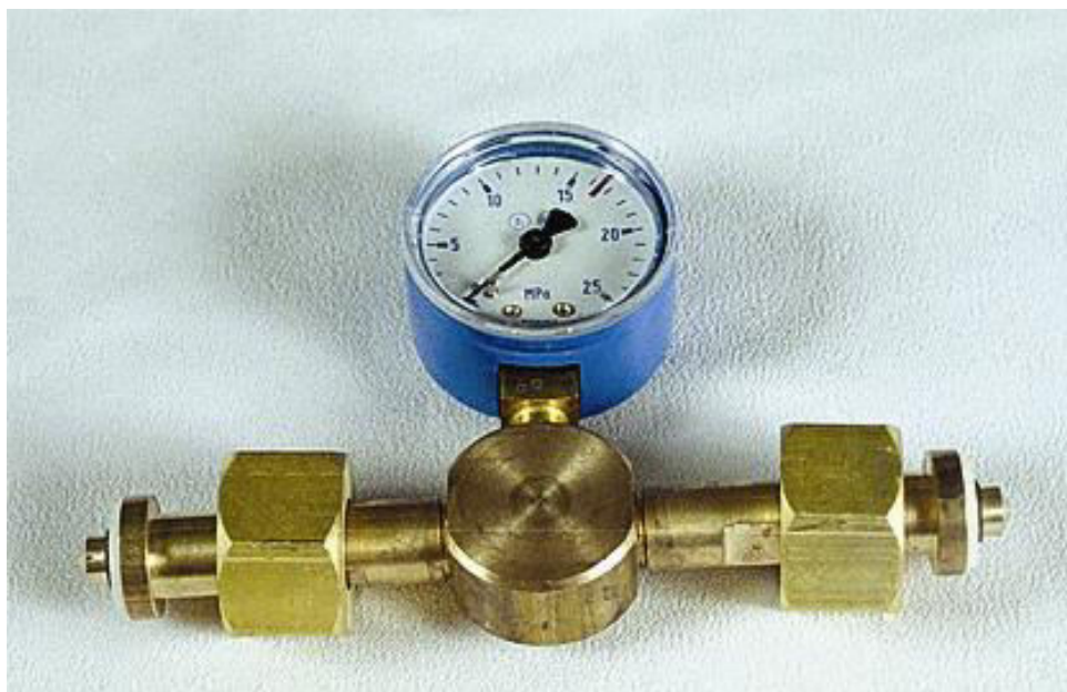
Рис. 1. Узел заправочный УЗК-1 ДЖЕТ 001 200 400.
