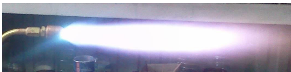
Рис.2 Пламя горелки ГЗУ ДЖЕТ 480 (7)
