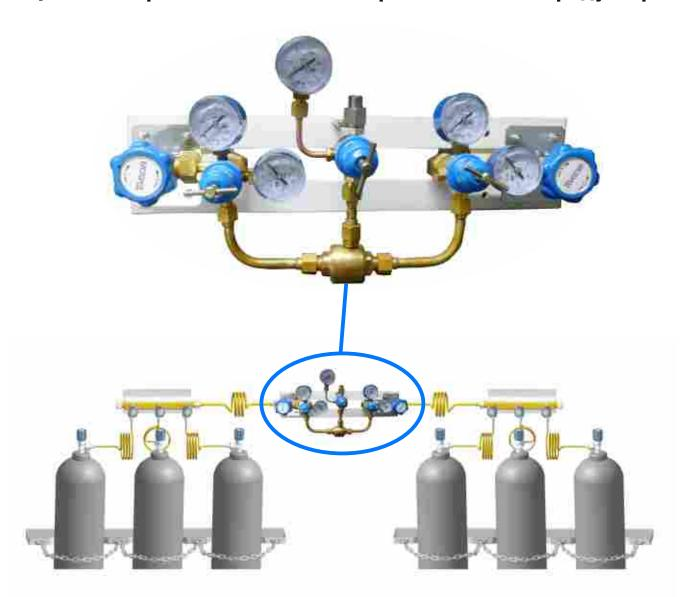
Предназначен для автоматического переключения с рабочего плеча рампы на резервное.
