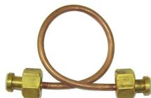
Змеевик ЗР длиной 200 мм (состоит из медной трубки 8x1,5 мм и 2х накидных гаек с внутренней резьбой G 3/4). Змеевик соединяет горизонтальные штуцеры тройника ТГС-20 в моноблоке.
