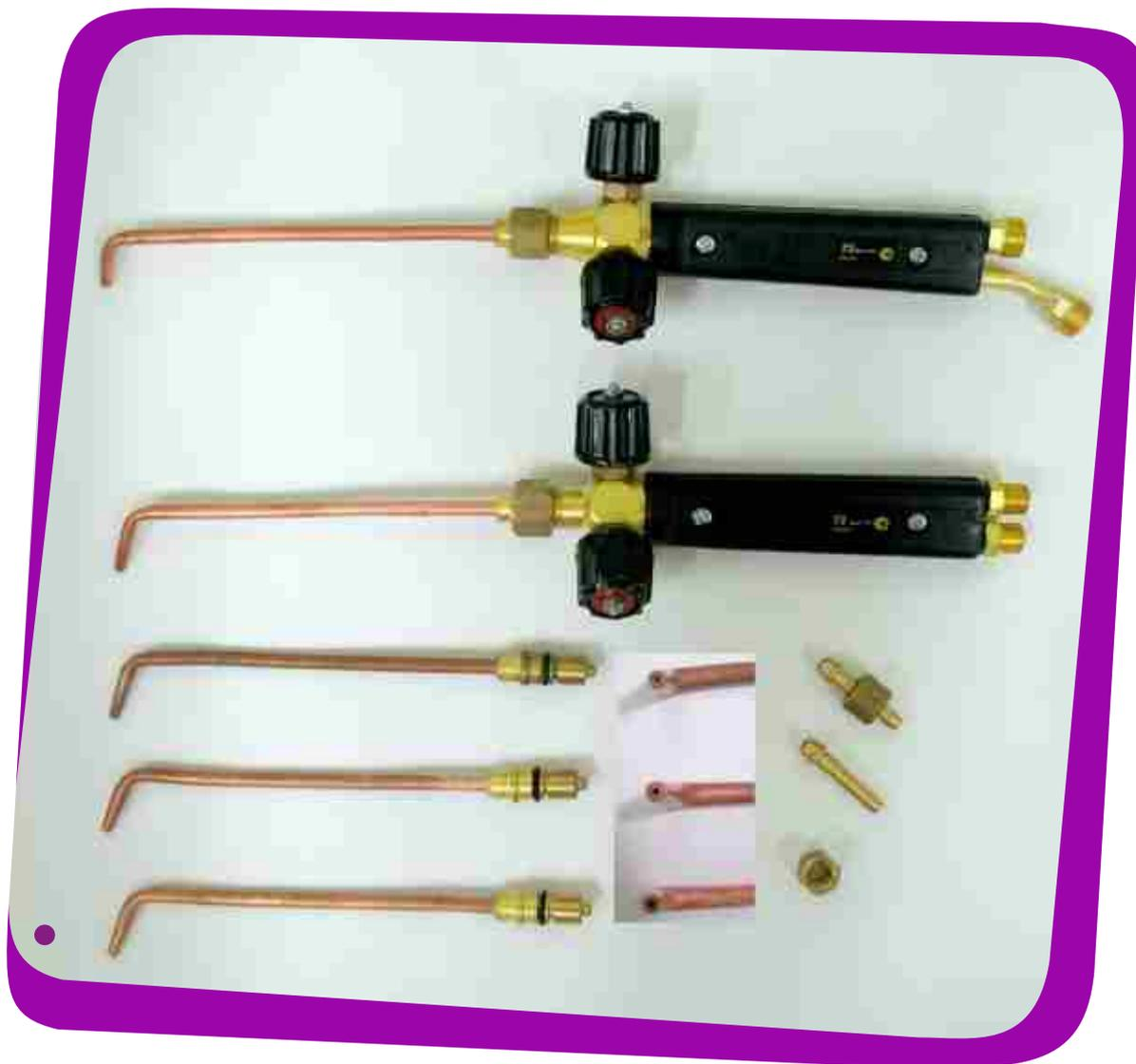
Цельнотянутые наконечники к газокислородным горелкам типов Г-2, Г-3 предназначены для использования в производстве, ручной сварки, нагрева, пайки мелким и твердым припоем материала толщиной в пределах от 0,1 мм до 4,0 мм.
